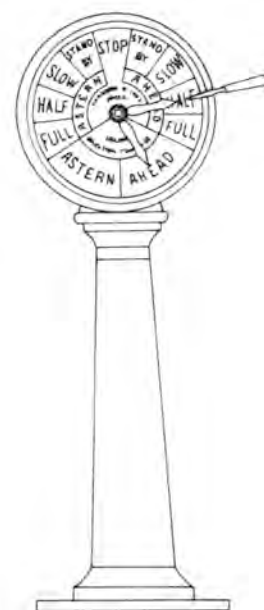
Телеграф машинного отделения, связь между мостиком и машинным отделением.
