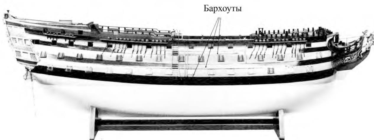
Корпусная модель английского трехпалубного корабля Воуле 1790 года
