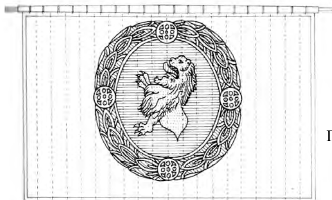
Немецкий грот и грот-марсель с модели Peller 1603 года, один из первых примеров нижней шкаторины с выемкой.
