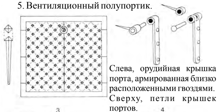
Орудийный порт: 1. Шпангоут; 2. Палуба; 3. Орудийный порт; 4. Рама; 5. Крышка орудийного порта; 6. Петли; 7. Порт-драйреп; 8. Порт-тали; 9. Порт-шкентель; 10. Гвоздь (для моделей)
