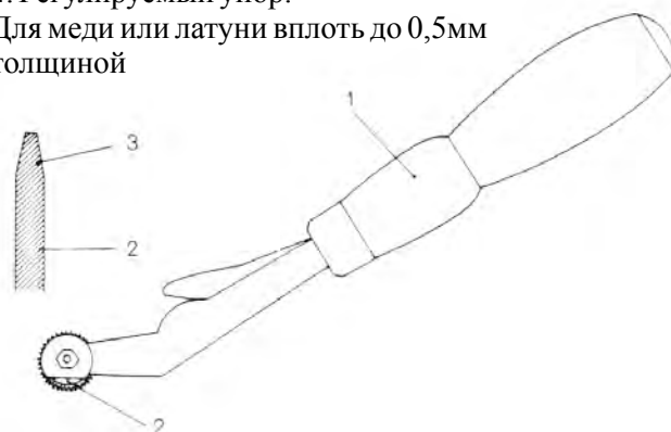
Колесико для тиснения гвоздей: 1. Рукоять; 2. Копир для края; 3. Заточка краев копира. Для меди и латуни вплоть до 0,1мм толщины.
