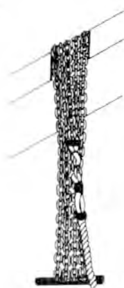
Цепной ватер-вулинг, 19 век
