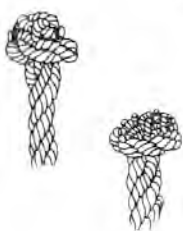
Сопорные кнопки на конце кат-стопора
