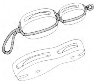
Сверху: Марса-шкот и галс-блок на одном стропе Снизу: Лонг-такель блок
